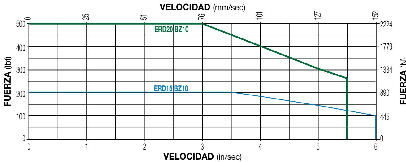
**LÍMITES PV:** Cualquier material que soporte una carga deslizante está limitado por la acumulación de calor. Los factores que afectan a la tasa de generación de calor en una aplicación son la presión sobre la tuerca en libras por pulgada cuadrada (P) y la velocidad de la superficie en pies por minuto (V). El producto de estos factores proporciona una medida de la severidad de una aplicación.
