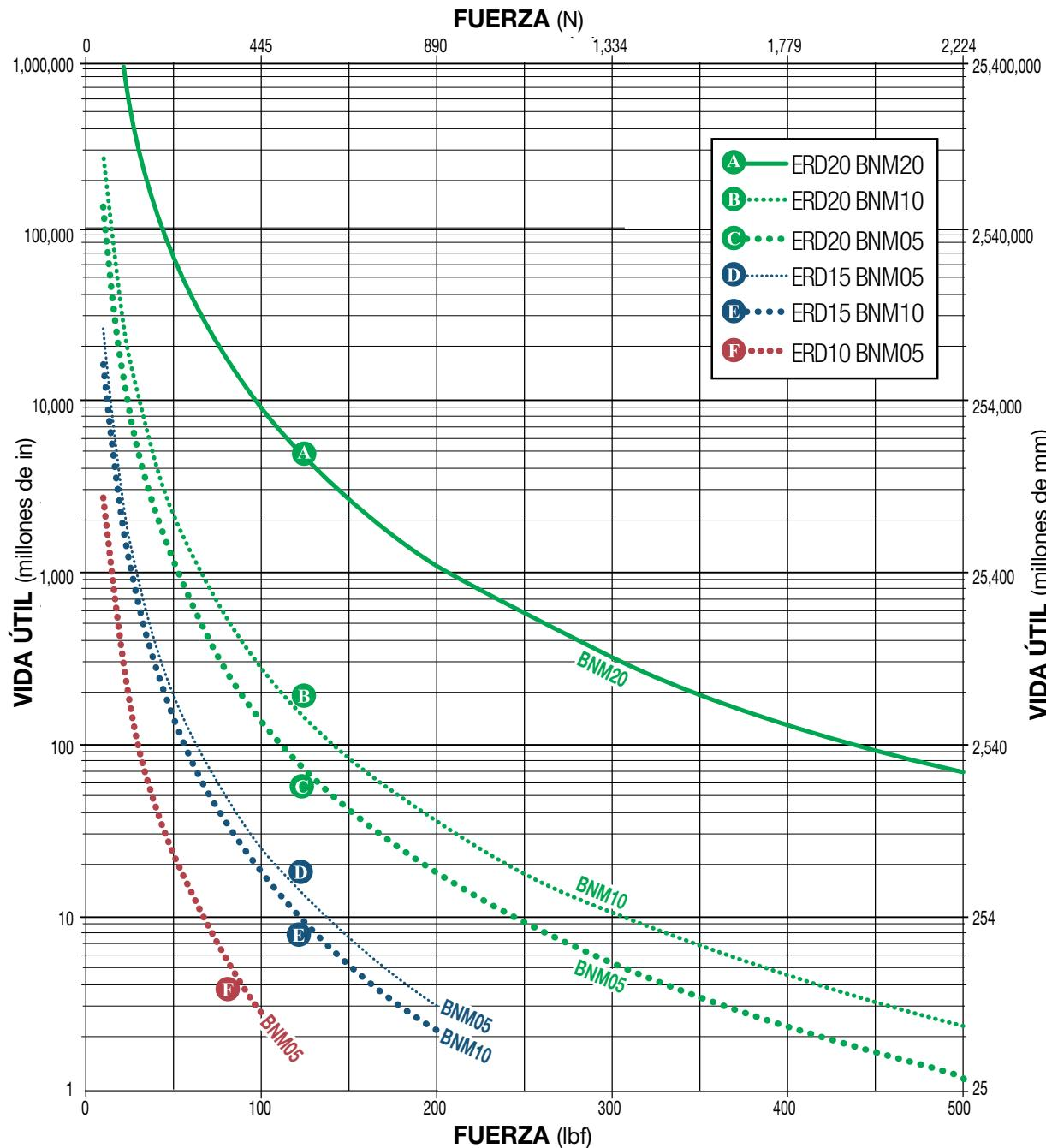
**NOTA:** La vida útil prevista  $L_{10}$  de un actuador lineal de tornillo de bolas se expresa como la distancia de recorrido lineal que se espera que el 90% de los tornillos de bolas fabricados, con un mantenimiento adecuado, alcancen o superen. Esto no es una garantía y este gráfico debe utilizarse únicamente con fines estimativos.
